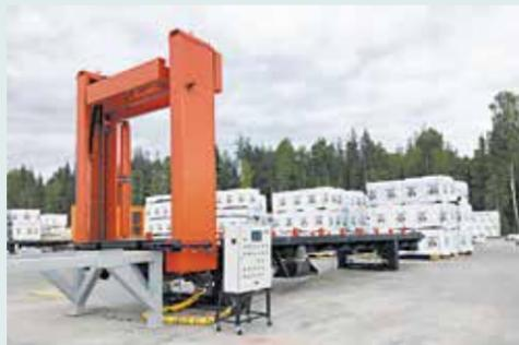
На территории склада готовой продукции установлено два новых загрузочных стола «Дано», теперь всего их три. Это современное оборудование предназначено для погрузки пиломатериалов в морские контейнеры. С помощью вилочного погрузчика пиломатериал, подлежащий погрузке, укладывается на загрузочную платформу, которая перемещает его в контейнер, установленный рядом. Такой способ погрузки является более быстрым и совершенным, минимизируются повреждения готовой продукции.
