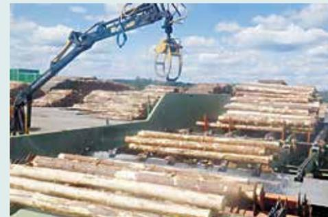
Первым этапом переработки древесины на Пестовском заводе является автоматическая линия сортировки круглых лесоматериалов. Лес доставляется в комплекс автомобильным и железнодорожным транспортом, на линию сортировки подается с помощью штабелера. Линия оборудована 44 карманами, скорость сортировки 150 м/мин. За сутки можно отсортировать до 3 тыс. куб. м 6-метрового или 2 тыс. куб. м 4-метрового пиловочника, что полностью обеспечивает сырьем лесопильную линию предприятия.
